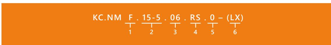
1. **F** — «F» — балансировочный клапан первичного контура, «R» — линия рециркуляции ГВС, «P» — наличие перепускного клапана.
