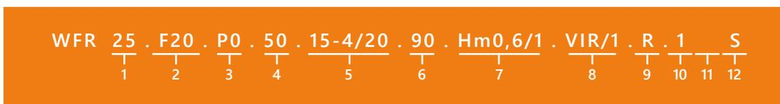
1. **25** — диаметр вводной группы (при подключении сверху или снизу добавить «L», с отводом после поворота «S»), длина патрубка 50мм, труба нерж.: 21,3×3; 26,9×3; 33,7×3; 42,4×3; 48,3×3; труба черная: 21,3×2,8; 26,8×2,8; 33,5×3,2; 42,3×3,5; 48×3,5. «25-2Pi» — установка 2-х манометров до и после фильтра на подающем коллекторе, «25/STR-2» — фильтр перед РПД.
