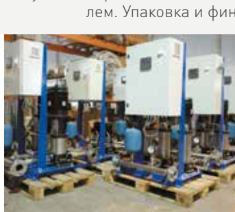
5. Ручная сборка насосных станций с полным выходным контролем. Упаковка и финальная комплектация.
